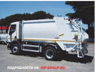
Уплотнение мусора выполняют поворотные плиты (одиночные или двойные), работающие по всей площади поперечного сечения кузова. Мусоровозы MIN- Выгрузка отходов осуществляется внутренней вытал-10 до 12 тонн.
