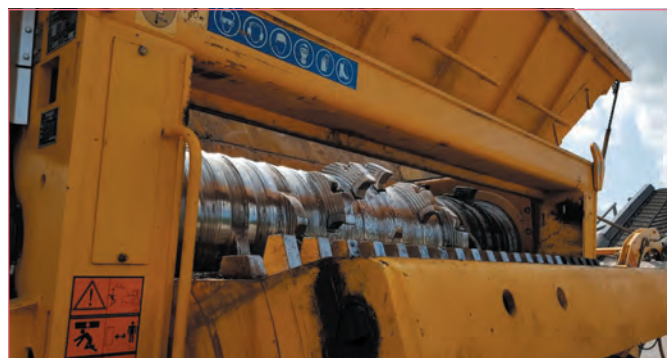
Фото 2. Измельчитель для крупногабаритных отходов TANA Shark
