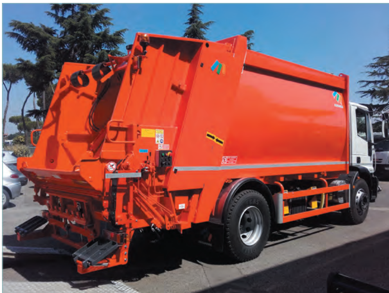
Фото 1. Мусоровоз Mazzocchia MAC3B с объемом бункера 12–18 м 3
