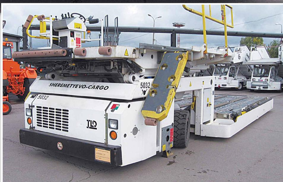
ка TXL-838, разработанный компанией TLD. Эта модель может обслуживать все эксплуатируемые типы пассажирских и грузовых ВС и может быть использована в грузовых терминалах аэропортов.
