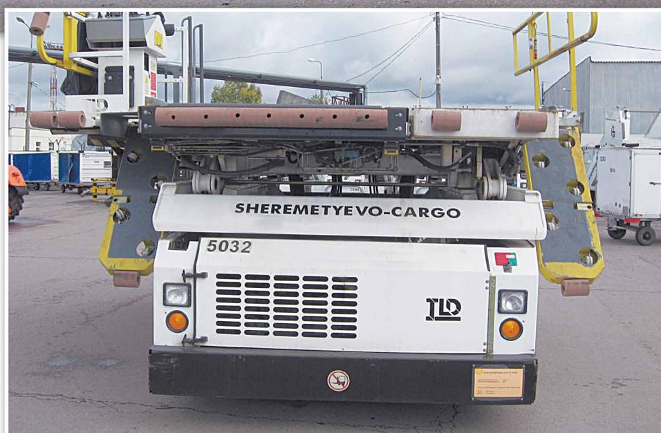
**Выкатная платформа для двигателя.** Это техническое решение позволяет облегчить проведение технического обслуживания и замены деталей на двигателе погрузчика.
