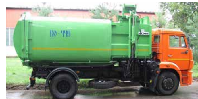
КО-449-19 объемом 15,5 м 3 производства «Мценск-Коммаш» на шасси КамАЗ-43253
