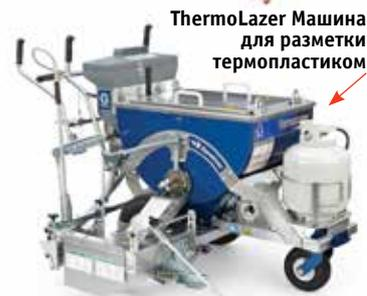
Thermolazer Машина для разметки термопластиком
